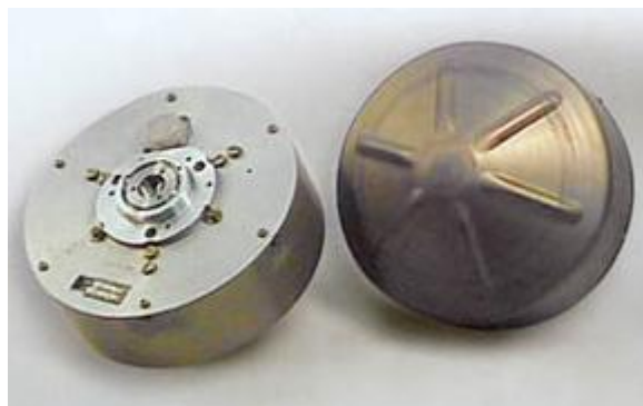
Рисунок 7 – Двигатель-маховик ДМ1-20, разработки ВНИИЭМ.
