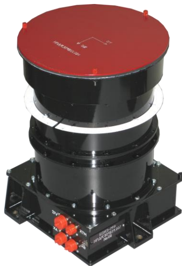
Рисунок 6 – Звездный датчик БОКЗ-МФ, разработки ИКИ РАН.
